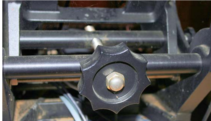
Illustration 8 – Meade Wedge Latitude Control Knob
