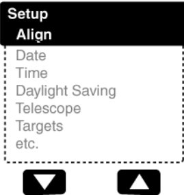
Fig. 26: La opción del menú se muestra en el segundo renglón. Use las flechas de avance para moverse hacia arriba o abajo en la lista de opciones. Presione ENTER para seleccionar la opción deseada.
